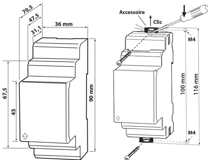
La flèche située à la base du boîtier indique l'endroit où le cache de la face avant peut être ouvert.
