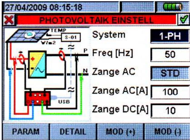
Ein Anschlussdiagramm im Farbdisplay unterstützt den Anwender beim korrekten Anschluss der Messleitungen an der zu messenden Installation
