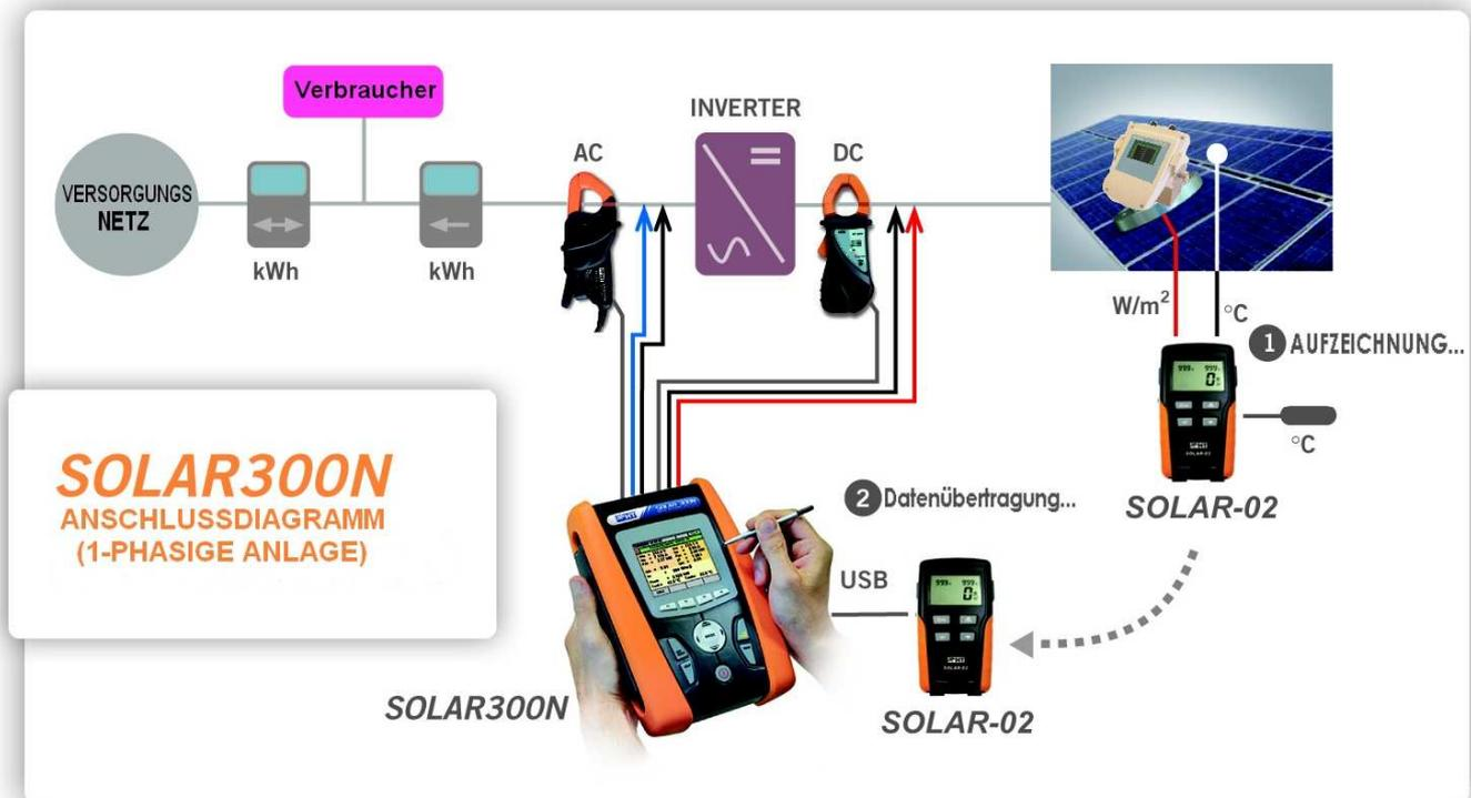
Am Ende der Aufzeichnung, werden die von SOLAR-02 erfassten Werte über eine USB-Verbindung zum SOLAR300N übertragen und weiter ausgewertet.
