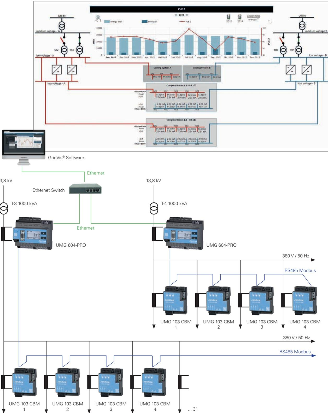
Abb.: Typische Applikationsabbildung mit 2 Einspeisungen, UMG 604-PRO als Master-Messgeräte in der Haupteinspeisung und UMG 103-CBM zur Messung der Niederspannungsabgänge.
