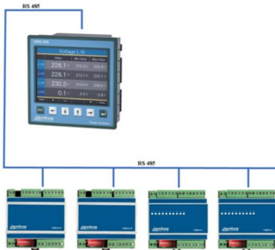
Als Displaygerät kann ein UMG 508 oder ein UMG 511 eingesetzt werden. Die Konfiguration der **Emax**-Parameter geschieht über die Homepage. Als I/O Module können bis zu 6 Output- und 6 Input-Module seriell angeschlossen werden. Somit stehen bis zu 60 Kanäle zur Abschaltung zur Verfügung. Bei Varianten mit Input-Modulen werden die Eingänge zur Sperrung oder Freigabe der Verbraucher herangezogen.
