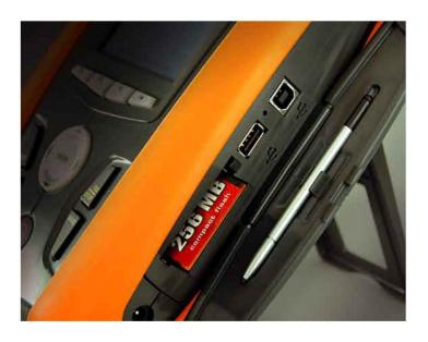
Eine externe Compact Flash Speicherkarte ermöglicht die Erweiterung des internen Datenspeichers (15Mbytes) bis auf über 2GB.
