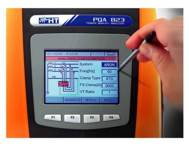
Ein grosses (320x240pixel) grafisches TFT-Farbdisplay mit "touch screen" Funktion ermöglicht einfachsten Zugang zu jeder Einstellung und Messfunktion
