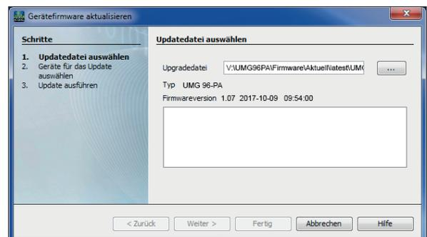
Abb. Geräte-Firmware aktualisieren in der Software GridVis®
