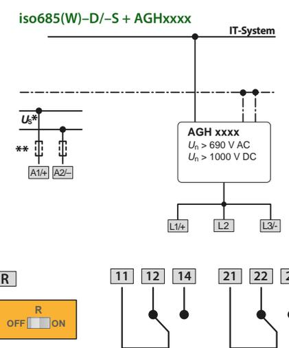
\* Para sistemas > 690 V y con categoría de sobretensión III debe instalarse un fusible en la conexión al sistema a vigilar. Recomendación: fusibles 2 A.
