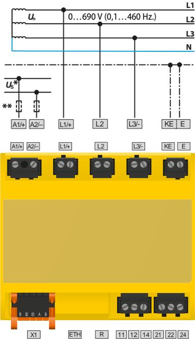
\* Bei Systemen > 690 V und Überspannungskategorie III ist eine Sicherung für das zu überwachende System vorzusehen. Empfehlung: 2A-Sicherungen.
