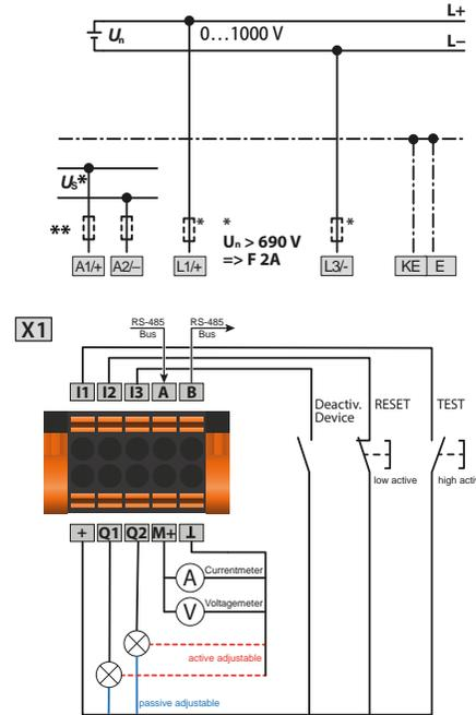
\* Dans des réseaux > 690 V et ayant une catégorie de surtension III, un fusible doit être prévu pour le raccordement au réseau à surveiller. Recommendation : fusibles à visser 2A.
