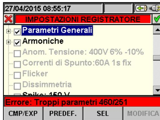
Fig. 83: Sezione Parametri Generali: troppi parametri selezionati
