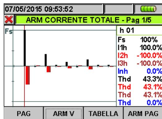
Fig. 42: Analisi armonica correnti in valore percentuale per sistemi trifase 4-fili
