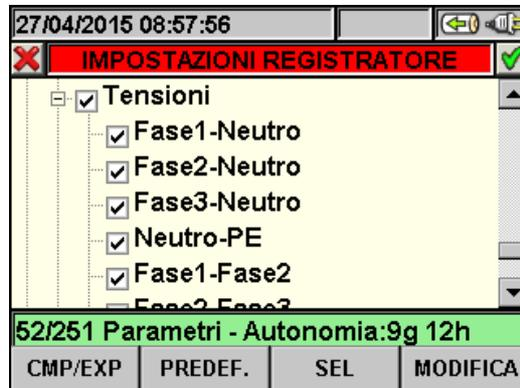
Fig. 84: Sottolivello Parametri Generali – Sistema trifase 4-fili
