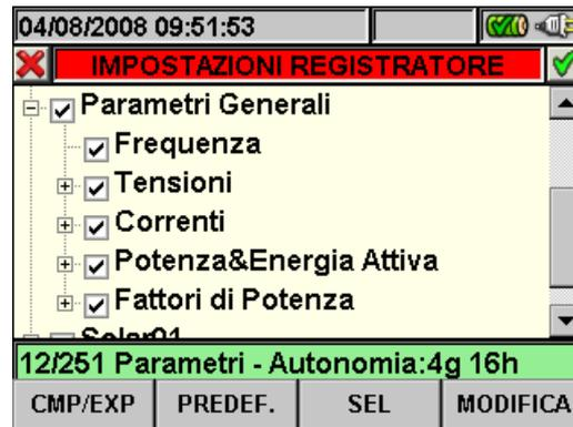
Fig. 73: Sezione Parametri Generali: parametri selezionati
