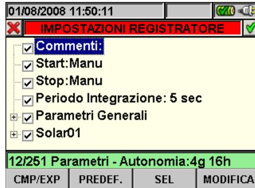
Fig. 70: Esempio di videata Impostazione Registrazione per Sistemi Fotovoltaici
