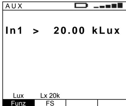
Valore rilevato superiore al fondo scala dello strumento
