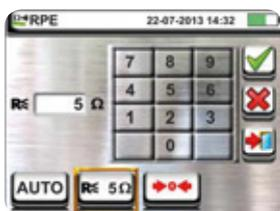
Selezione limite massimo della resistenza di misura
