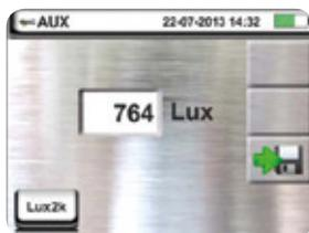
Visualizzazione in Real Time della misura di LUX
