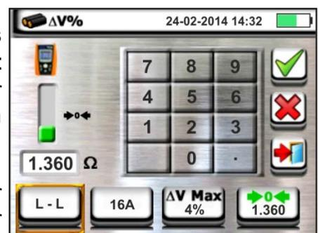
4. Berühren Sie das Symbol zur Nullstellung des Wertes im Feld "A" und stellen Sie den Wert des Nennstroms der Schutzeinrichtung zwischen **1A** und **9999A** mit der virtuellen Tastatur ein. Bestätigen Sie die Einstellungen und kehren Sie zum vorherigen Bildschirm zurück.
