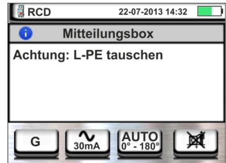
8. Wenn der zu testende RCD-Schutzschalter während der Vortestphase (die das Gerät vor der ausgewählten Prüfung automatisch ausführt) auslöst, führt das Gerät keine Prüfung durch und zeigt einen Bildschirm ähnlich dem hier nebenstehenden an. Vergewissern Sie sich, dass der eingestellte Wert für  $I_{dN}$  dem angeschlossenen RCD-Schutzschalter entspricht, und dass alle dem Schutzschalter nachgelagerten Verbraucher abgeklemmt sind.
