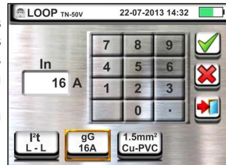
5. Berühren Sie das Feld "**mm<sup>2</sup>**" und, mit Hilfe der numerischen Tastatur, stellen Sie ein und bestätigen Sie den Querschnitt des einzelnen Leiters unter den Werten frei frei wählbar
