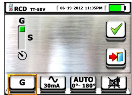
3. Berühren Sie das Symbol
