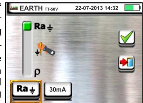
Berühren Sie das zweite Symbol unten links zur Einstellung des Auslösestroms des RCD-Schalters (TT und IT Systeme). Der folgende Bildschirm erscheint im Display:
