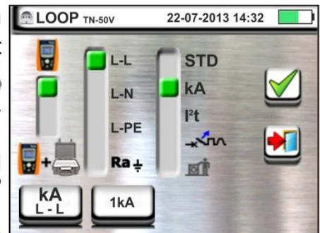
3. Berühren Sie das Symbol
