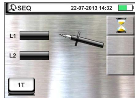
7. Das Symbol des Tastkopfes auf der Phase L2 in Zusammenhang mit der Sanduhr zeigen an, dass das Messgerät die Spannung noch ermittelt.
