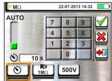
4. Berühren Sie das Symbol "R≥xxΩ" zur Einstellung des minimalen Grenzwertes des Isolationswiderstandes, den das Gerät mit dem gemessenen Wert vergleicht. Der hier nebenstehende Bildschirm erscheint im Display.
