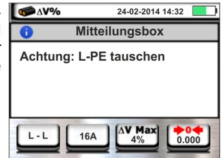
8. Erkennt das Gerät eine gefährliche Spannung auf dem PE-Leiter, führt es keine Prüfung durch und zeigt einen Bildschirm ähnlich dem hier nebenstehenden an. Diese Meldung kann auch bei ungenügendem Drücken der **GO/STOP** Taste erscheinen
