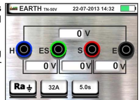
5. Berühren Sie das Symbol
