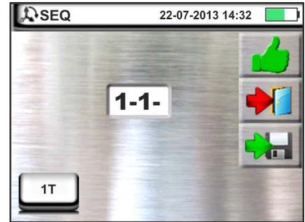
10. Ist der Testvorgang mit nicht korrekter Drehfeldrichtung (beendet, zeigt das Gerät einen Bildschirm ähnlich dem hier nebenstehenden an (Ergebnis "2-1-3" => linkes Drehfeld).
