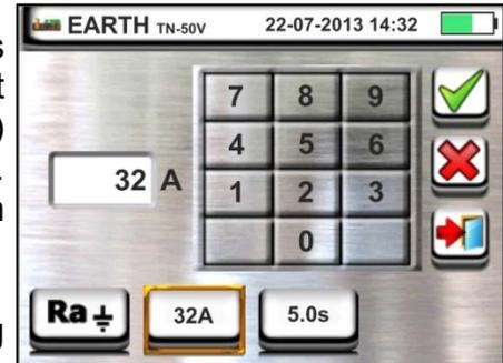
Berühren Sie das Symbol unten rechts zur Einstellung der Auslösezeit des Schutzschalters. Der folgende Bildschirm erscheint im Display:
