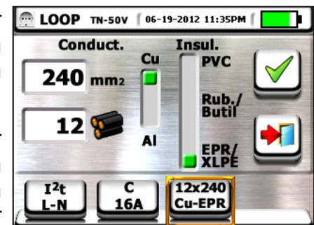
6. Trennen Sie, wenn möglich, alle dem Messpunkt nachgelagerten Verbraucher ab, denn deren Impedanz kann die Testergebnisse verfälschen. Verbinden Sie den Schukostecker, die Krokodilklemmen oder den Tastkopf mit der elektrischen Anlage entsprechend Abb. 16, Abb. 17, Abb. 18 und Abb. 20
