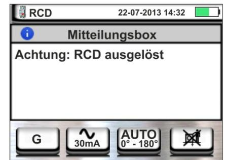
9. Falls das Gerät ein gefährliches Potenzial auf dem PE-Leiter ermittelt, unterbricht es die Prüfung und zeigt die nebenstehende Meldung an. Überprüfen Sie die Leistung des PE-Leiters und der Erdinstallation. Diese Meldung kann auch bei ungenügendem Drücken der **GO/STOP** Taste erscheinen
