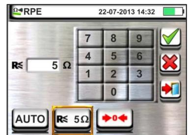
5. Kompensieren, gegebenenfalls, Sie den Widerstand der Messanschlüsse durch Verbindung der Kabel oder des Tastkopfes wie in Abb. 7 gezeigt.
