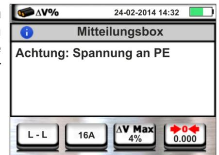
9. Erkennt das Gerät eine Spannung VN-PE >50V (oder > 25V je nach den Einstellungen), führt es keine Prüfung durch und zeigt einen Bildschirm ähnlich dem hier nebenstehenden an
