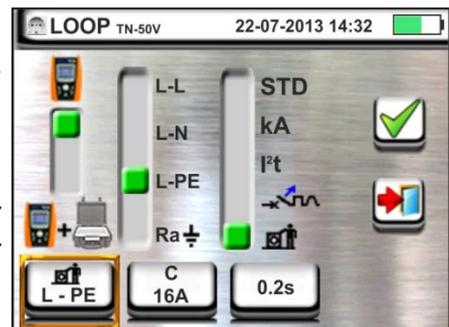
3. Bewegen Sie den Cursor auf der Leiste und wählen Sie den Schutztyp aus: Schmelzsicherung Typ **gG** oder **aM**) oder Leistungsschutzschalter (MCB) mit Charakteristik **B, C, K, D**.
