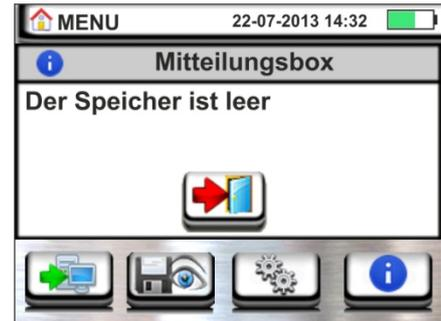
2. Falls Sie versuchen, einen neuen Unterknoten über der 3. Ebene zu definieren, zeigt das Gerät einen Bildschirm ähnlich dem hier nebenstehenden an und unterbricht die Funktion
