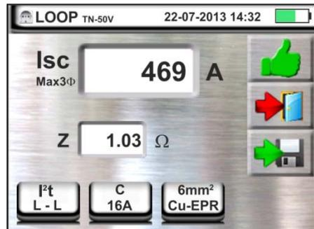
8. Bei negativem Testergebnis (der voraussichtliche dreiphasige Kurzschlussstrom im Fall Zpp, also Phase-Phase, kann vom Leiter mit den ausgewählten Einstellungen **NICHT** getragen werden) zeigt das Gerät die hier nebenstehende Bildschirmseite an.
