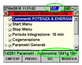
Fig. 154: Esempio di uso della memoria esterna - presenza Compact Flash
