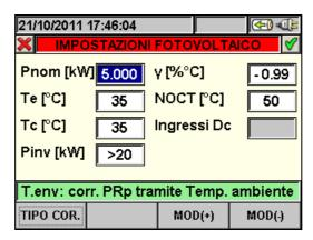
Fig. 65: Videata Impostazioni Parametri per sistemi Fotovoltaici
