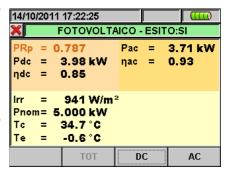
Esempio di esito in abbinamento a MPP300
