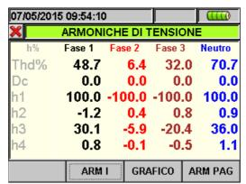
Fig. 43: Analisi armonica numerica percentuale tensioni per sistemi 4-fili
