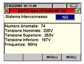
Fig. 130:Parametri impostati per l'analisi EN50160
