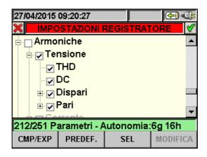
Fig. 85: Sottolivello Armoniche – selezione iniziale parametri
