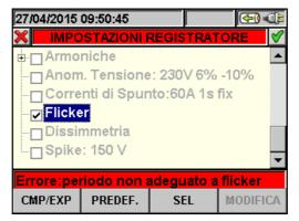
Fig. 95: Videata selezione Flicker – errato periodo di integrazione In tal caso selezionare la voce "Periodo di Integrazione" e impostare un valore corretto come descritto nel § 5.4.2.4. Premere i i tasti **SAVE** o **ENTER** (o la smart icon ☑) per salvare ogni
