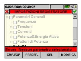
Fig. 72: Sezione Parametri Generali: nessuna selezione
