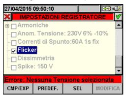
Fig. 94: Videata selezione Flicker - Nessuna tensione selezionata Nel caso in cui il periodo di integrazione impostato sia **inferiore a 1minuto o superiore ai 15minuti**, lo strumento presenta la seguente videata di errore:
