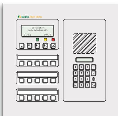
I pannelli di visualizzazione allarmi e di controllo della serie TM forniscono su un visualizzatore LCD segnalazioni di servizio e di allarme con specifici messaggi di testo su più righe. Di base ogni segnale fornito da ingressi e uscite digitali o dall'interfaccia seriale viene associato ad un messaggio di testo dedicato.
