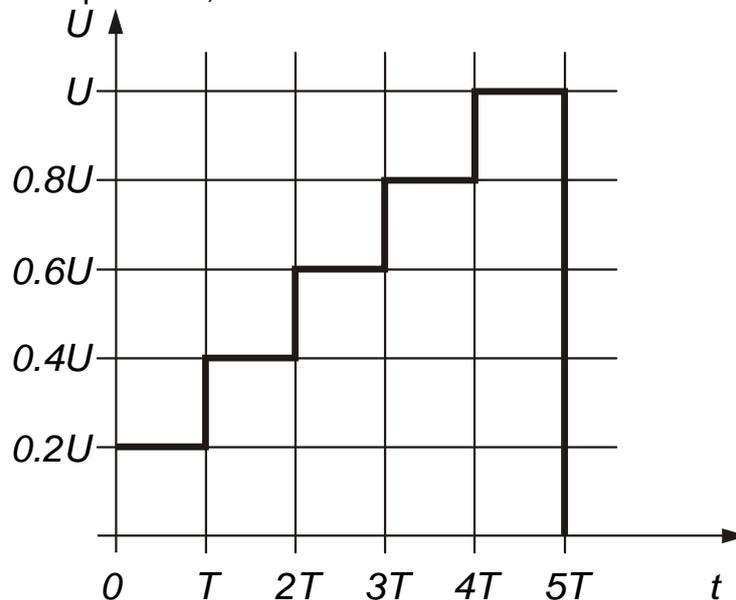
**Abb. 23.** Stufenweise erhöhte Prüfspannung
