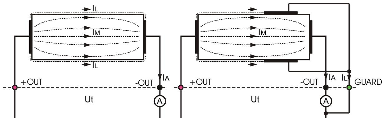
**Abb. 8** Verbindung des GUARD-Anschlusses mit dem Messobjekt
