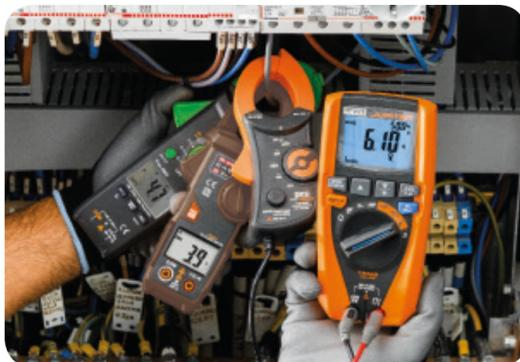
Messwertvergleich: 3.9A: mit RMS Zange - 4.7A: mit TRMS Zange
