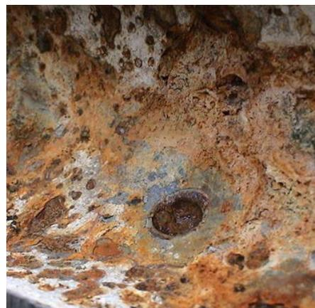
Unzulässige Ströme auf Betriebsmitteln: Schadensbilder korrodierter Wasserleitungen von belasteten Rohrsystemen sind unregelmäßige, punktförmige Korrosionsbilder, Lochfraß und kraterartige Rostbildung.
