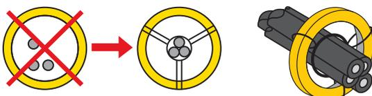
Die Leitungen/Leiter sind in der Mitte des Messstromwandlers zu zentrieren.
