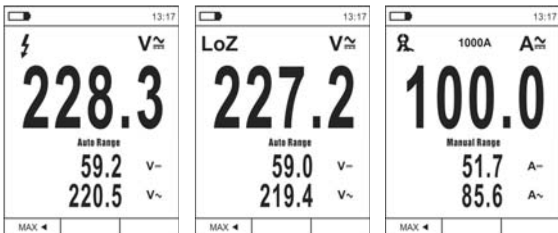
Fig. 6: Descrizione misura tensione e corrente AC+DC
