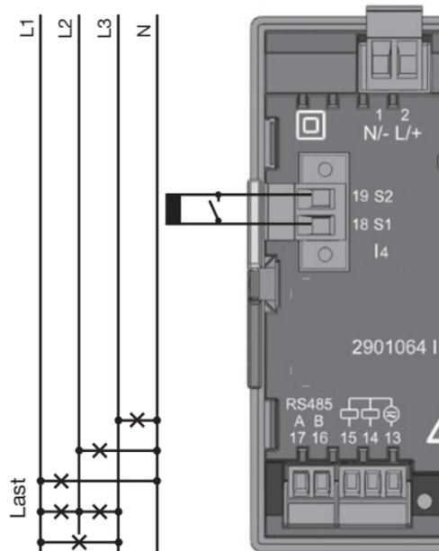
Abb. Strommessung (I4) über Stromwandler (Anschlussbeispiel)
