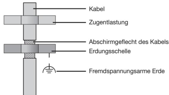
Abb. Abschirmungsauslegung bei Schrankeintritt.
