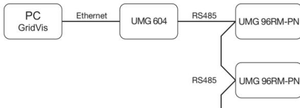
Anschluss eines UMG 96RM-PN an einen PC/SPS über Ethernet / ProfiNet.
