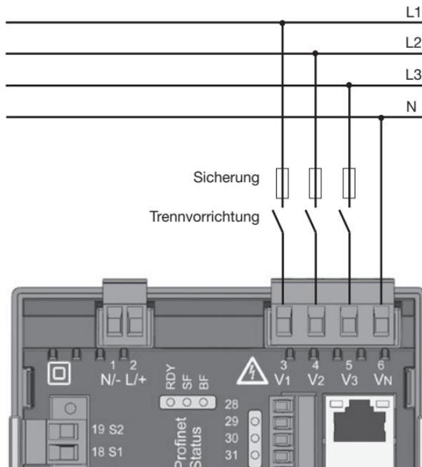
Abb. Anschlussbeispiel für die Spannungsmessung
