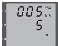
*Abb. Programmier-Modus Stromwandler*
