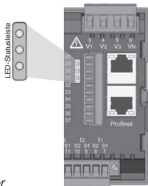
Abb. LED-Statusleiste der Ein- bzw. Ausgänge
