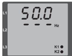
Abb. Keine Drehfeldrichtung feststellbar.
