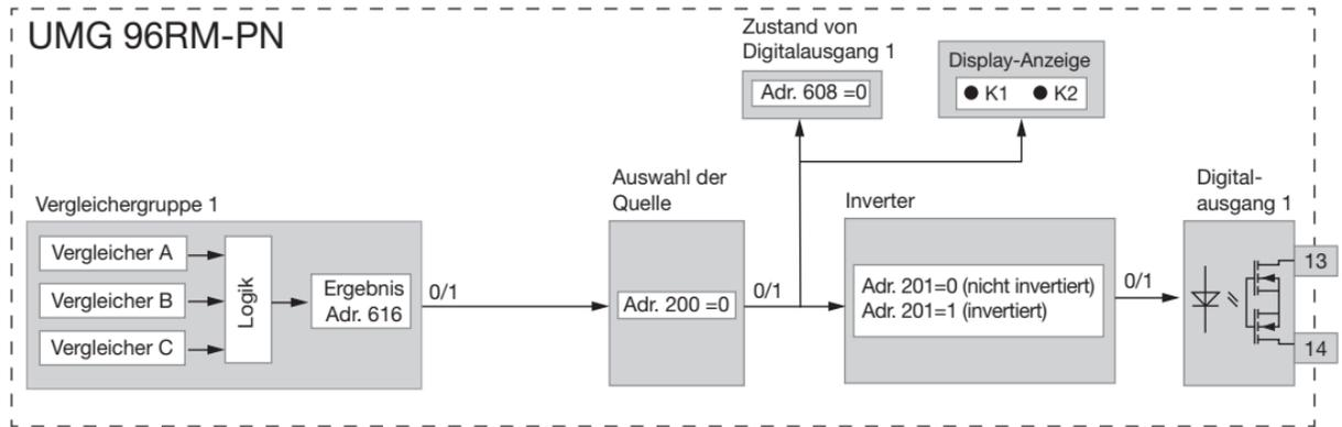
Blockschaltbild: Verwendung des Digitalausganges 1 zur Grenzwertüberwachung.
