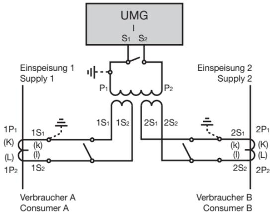
Abb. Strommessung über einen Summenstromwandler (Beispiel).
