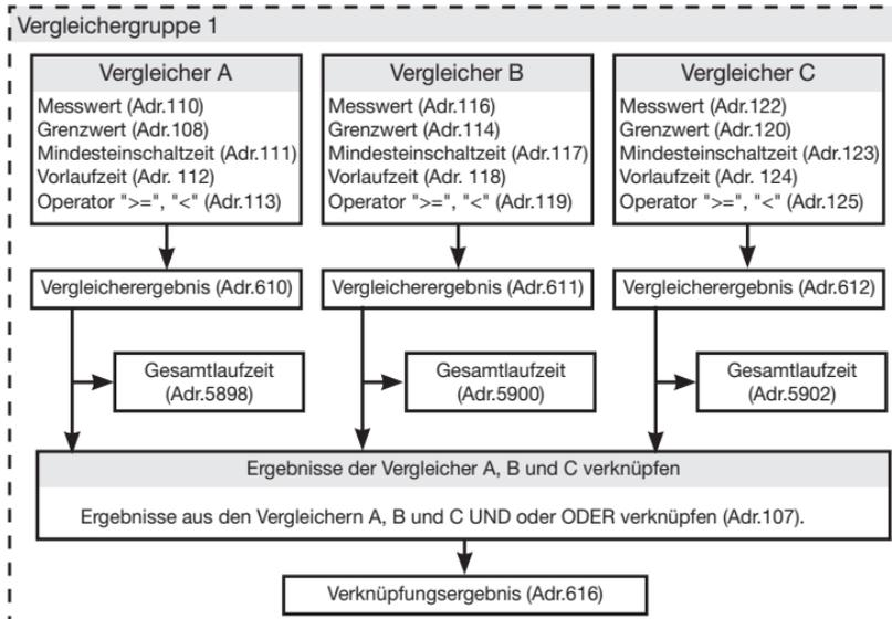
Abb.: Vergleichers-Prinzip der Vergleicherguppe 1
