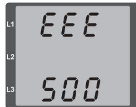
Abb. Warnmeldung mit Nummer 500 (Netzfrequenz)
