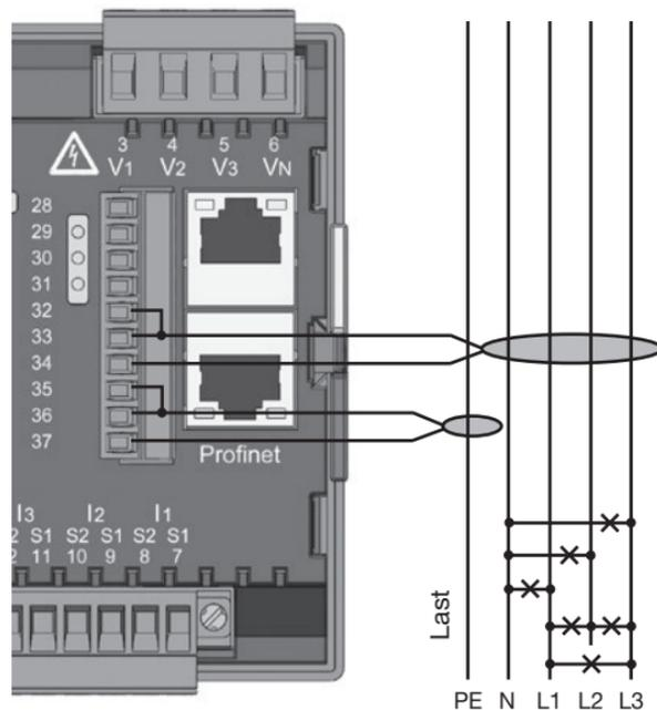
Abb. Anschlussbeispiel Differenzstrommessung über Stromwandler
