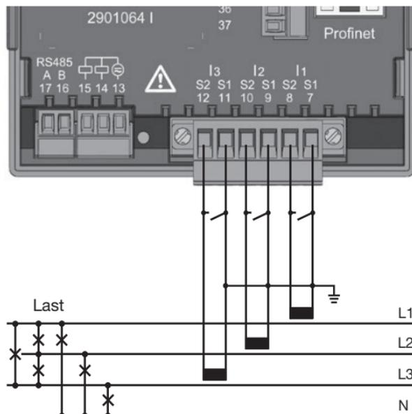
Abb. Strommessung (I1-I3) über Stromwandler (Anschlussbeispiel)
