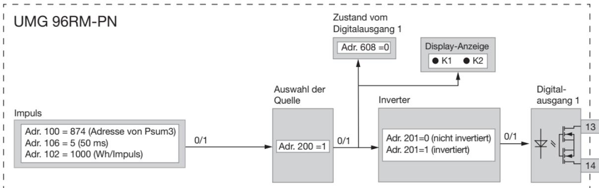
Abb.: Blockschaltbild; Beispiel Digitalausgang 1 als Impulsausgang.
