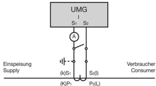
Abb. Strommessung mit einem zusätzlichen Amperemeter (Beispiel).
