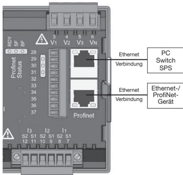
Das UMG 96RM-PN besitzt zwei gleichwertige Ethernet-Schnittstellen. Hierdurch ist es möglich, über die zweite Schnittstelle ein weiteres Ethernet/ProfiNet-Endgerät zu betreiben und somit den Verkabelungsaufwand zu reduzieren.
