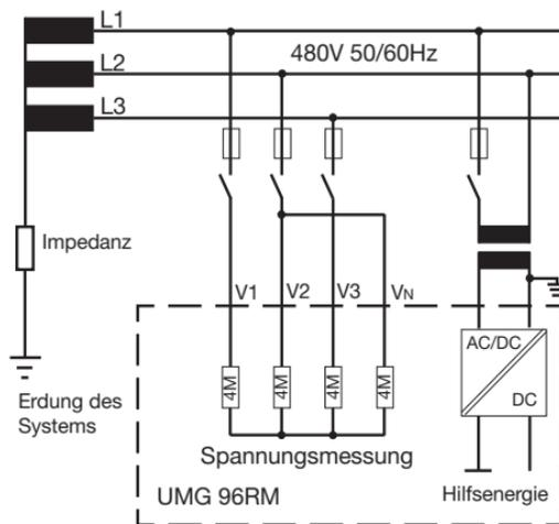
Abb. Prinzipschaltbild - Messung in Dreiphasen-4-Leitersystemen.
