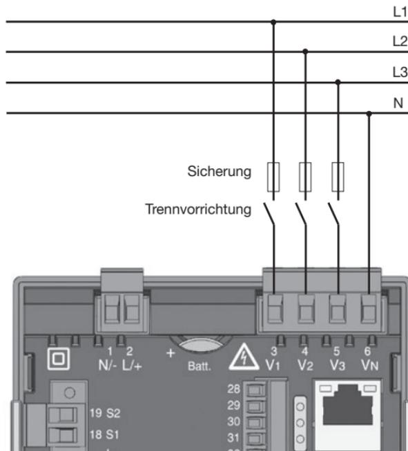
Abb. Anschlussbeispiel für die Spannungsmessung
