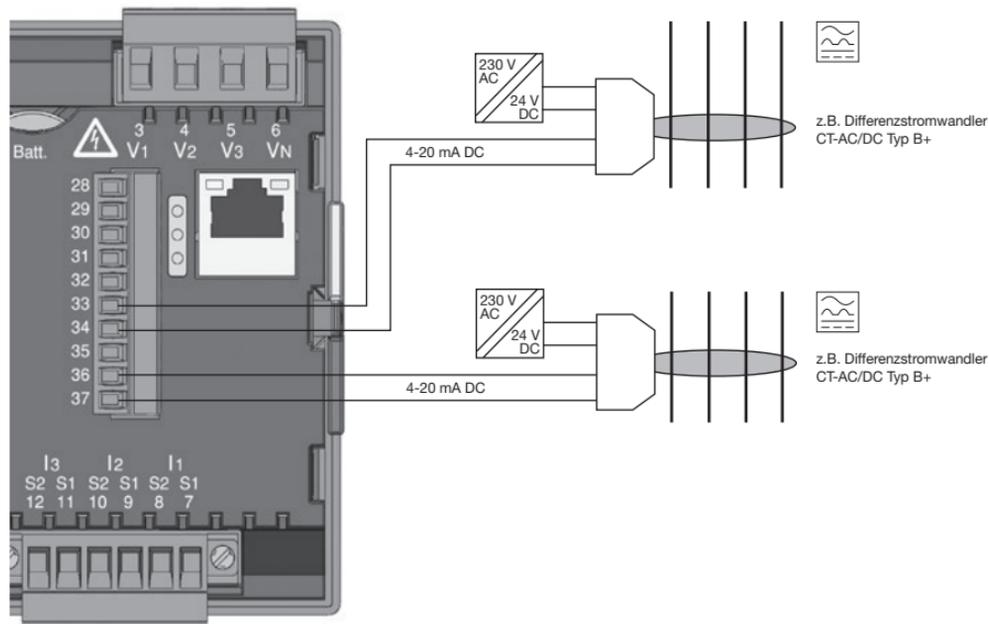
Anschlussbeispiel zur Messung von Differenzströmen vom Typ B. Jeder Differenzstromwandler der Baureihe *CT-AC/DC Typ B+ RCM* benötigt ein eigenes Netzteil (mit  $U = 24\text{V DC}$ , Restwelligkeit  $< 5\%$ , Leistung:  $24\text{W}$ ). **Die Sekundärseiten der Netzteile (24V DC) müssen galvanisch voneinander getrennt sein!**
