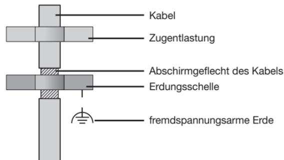
Abb. Abschirmungsauslegung bei Schrankeintritt.
