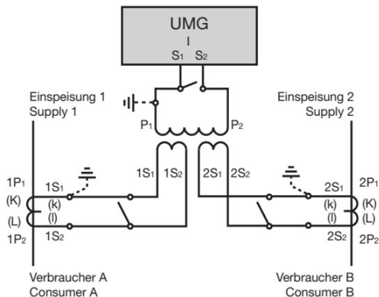
Abb. Strommessung über einen Summenstromwandler (Beispiel).
