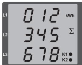
*Die in diesem Beispiel angezeigte Wirkenergie beträgt: 134 178 kWh*
