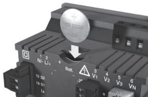
Abb. Batterieeinschub auf der Rückseite
