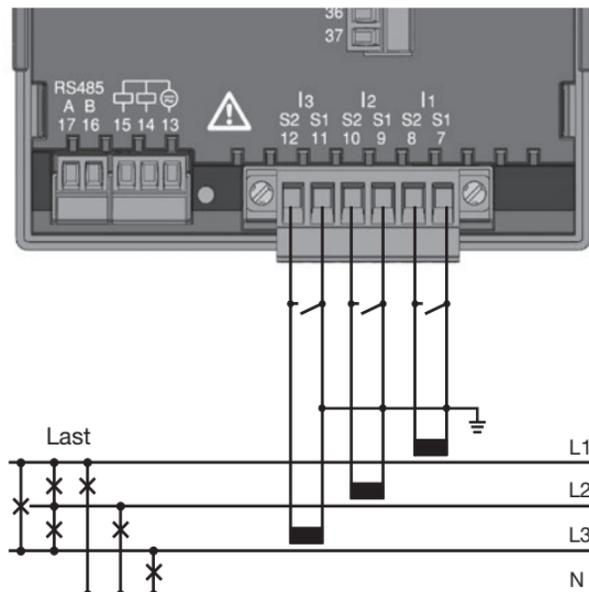
Abb. Strommessung (I1-I3) über Stromwandler (Anschlussbeispiel)
