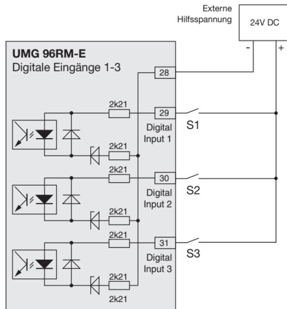
Abb. Beispiel für den Anschluss der externen Schalt-
