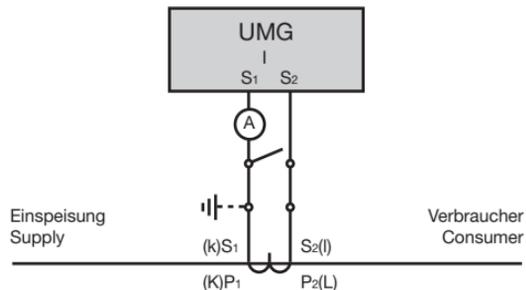
Abb. Strommessung mit einem zusätzlichen Amperemeter (Beispiel).
