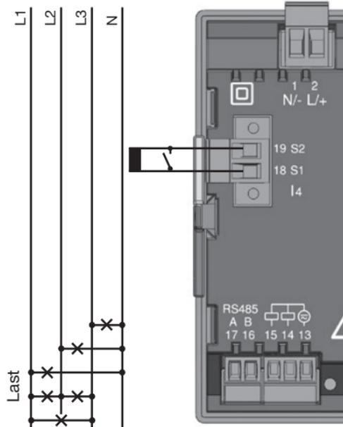
Abb. Strommessung (I4) über Stromwandler (Anschlussbeispiel)
