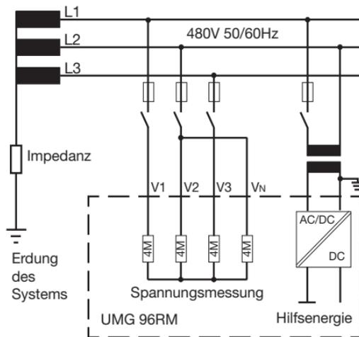
Abb. Prinzipschaltbild - Messung in Dreiphasen-4-Leitersystemen.
