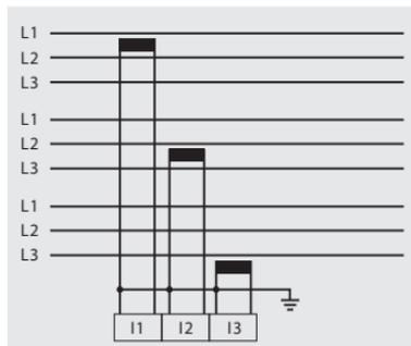
Abb. 3 Systeme mit gleichmäßiger Belastung der Phasen. Die nicht angelegten Messwerte I2/I3 bzw. I1/I3 bzw. I1/I2 der jeweiligen Systeme werden berechnet.
