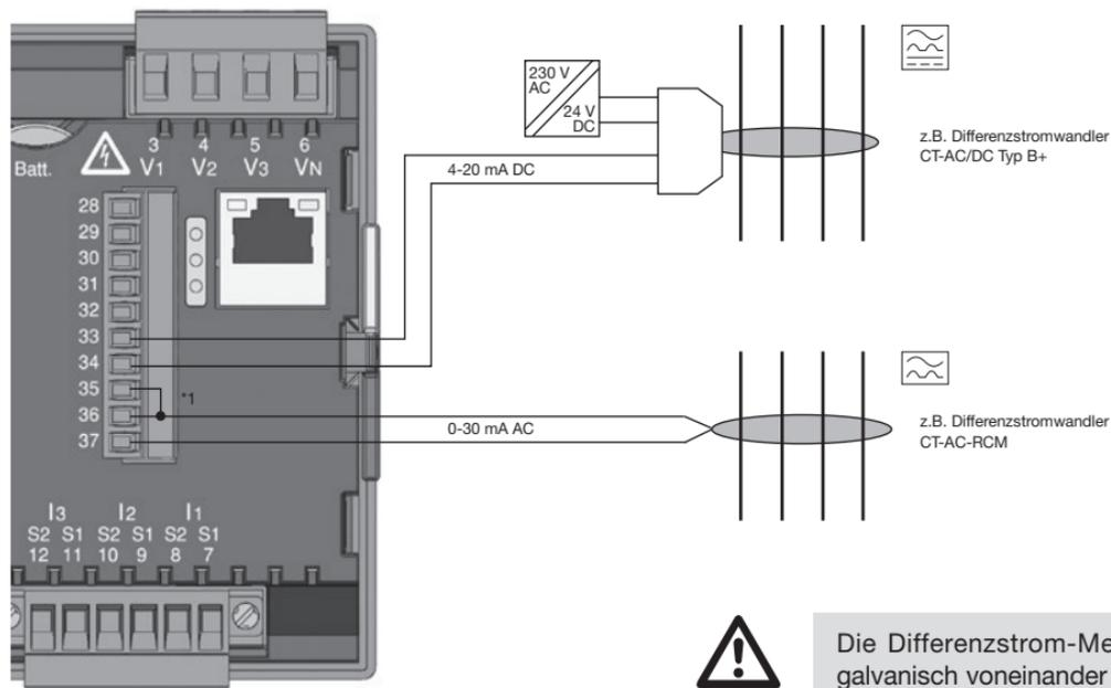
Anschlussbeispiel zur Messung von Differenzströmen vom Typ B und A. (Netzteil mit  $U = 24\text{V DC}$ , Restwelligkeit  $< 5\%$ , Leistung:  $24\text{W}$ )
