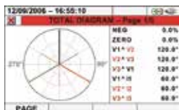
Vektordiagramm-Funktion bei jedem Modell
